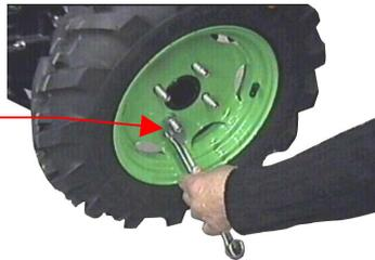
Svitare le viti delle ruote con una chiave adatta (una ruota alla volta)
