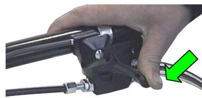
5 - Spostare la manetta dell'acceleratore al massimo della sua corsa
